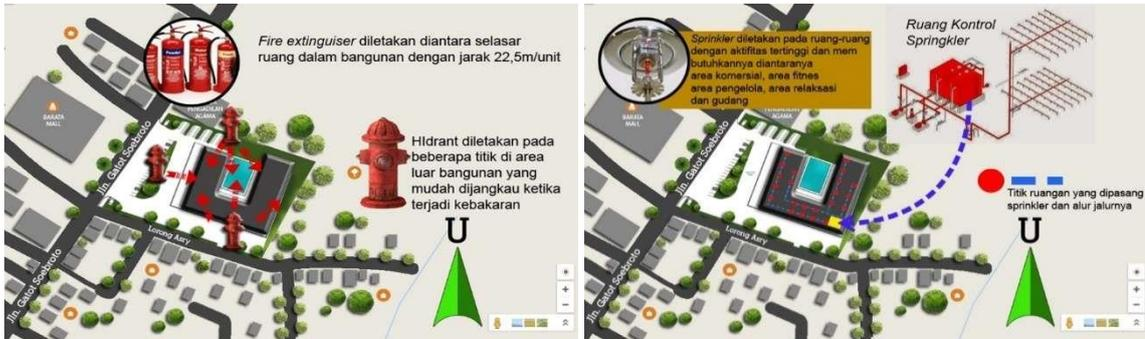
Gambar 9. konsep penerapan pemadam kebakaran hidran dan *sprinkler*.
