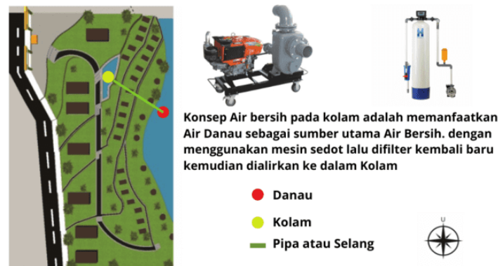
Gambar 11. Konsep Sistem Air Bersih
