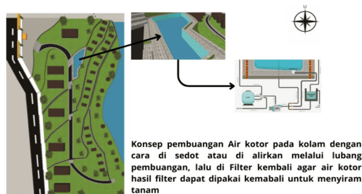
Gambar 12. Konsep Sistem Air Kotor
