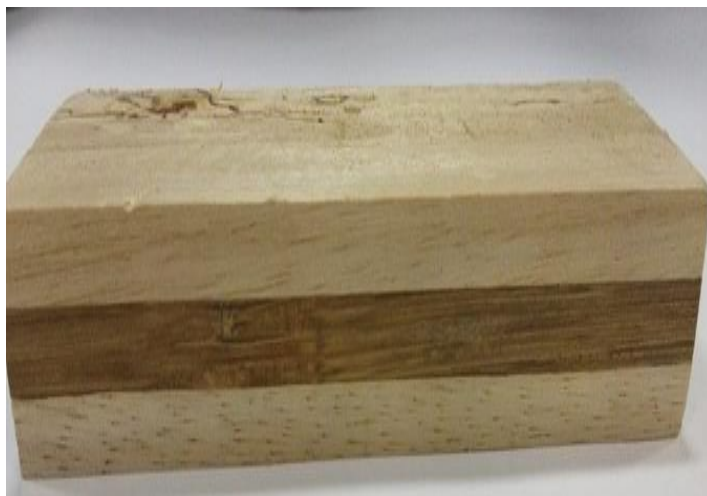
Gambar 1. Pola penyusunan kayu kemiri dan bambu petung
