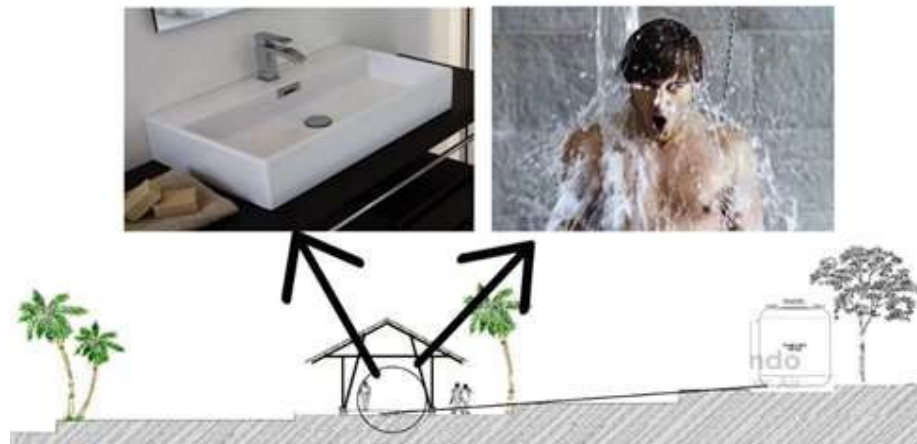
Gambar 10 : pemanfaatan kontur untuk pendistribusian air
