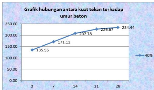
Gambar 5. Grafik hubungan antara kuat tekan terhadap umur beton dengan menggunakan pasir laut 40% dan pasir kali 60%
