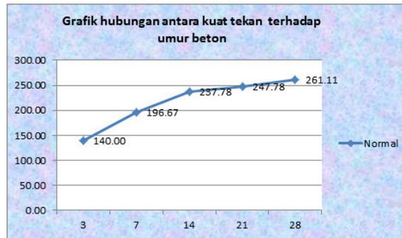
**Gambar 1. Grafik hubungan antara kuat tekan terhadap umur beton dengan menggunakan pasir laut 0% dan pasir kali 100%**
