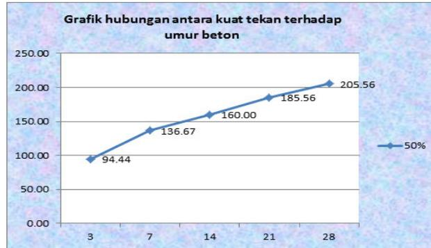
**Gambar 6. Grafik hubungan antara kuat tekan terhadap umur beton dengan menggunakan pasir laut 50% dan pasir kali 50%**
