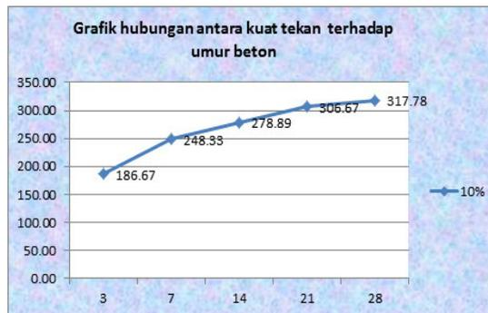
**Gambar 2. Grafik hubungan antara kuat tekan terhadap umur beton dengan menggunakan pasir laut 10% dan pasir kali 90%**
