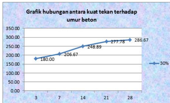
Gambar 4. Grafik hubungan antara kuat tekan terhadap umur beton dengan menggunakan pasir laut 30% dan pasir kali 70%
