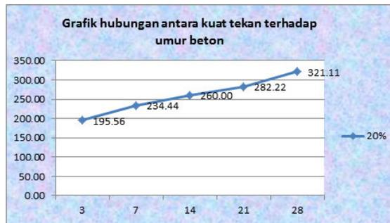
Gambar 3. Grafik hubungan antara kuat tekan terhadap umur beton dengan menggunakan pasir laut 20% dan pasir kali 80%
