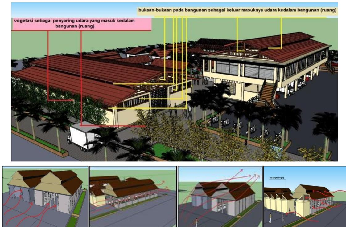
Gambar 6. Peletakan bangunan terhadap penghawaan alami
