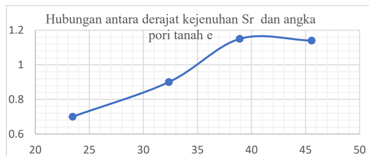
Gambar 1. Hubungan antara derajat kejenuhan Sr dan angka pori tanah e
