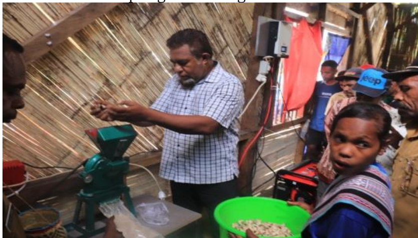
Gambar 3. Mesin penepung dengan kapasitas produksi 50 kg/jam
