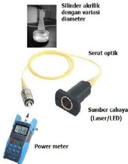
**Gambar 3.** Set up pengukuran rugi lengkungan serat optik
