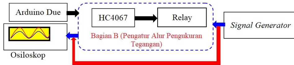
Gambar 4. Skema pengujian bagian B (Pengatur alur pengukuran tegangan)
