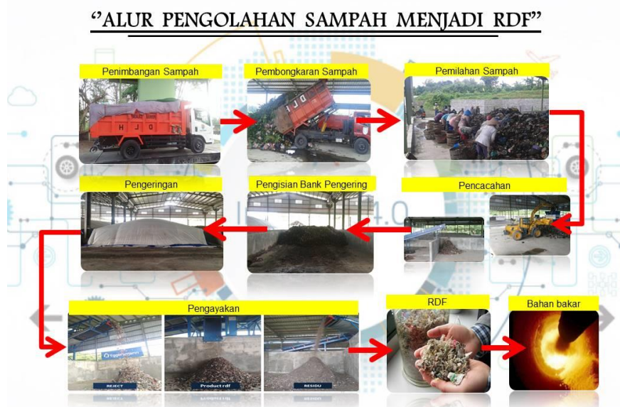
Gambar 2. Proses pengolahan sampah menjadi RDF
