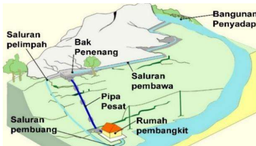
Gambar 2. Skema pembangkit listrik tenaga mini/mikro hidro (Gunawan et al., 2014)
