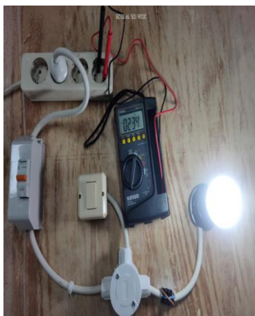
Gambar 3. Dokumentasi Pengujian Rangkaian dengan Spesimen Lampu LED Menyala
