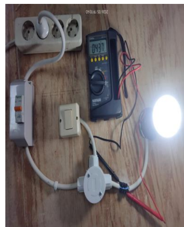
Gambar 3. Dokumentasi Pengujian Rangkaian dengan Spesimen Lampu LED Menyala
