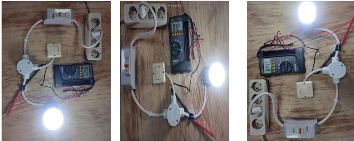
Gambar 4. Dokumentasi Pengukuran Arus pada Berbagai Posisi Titik Ukur dalam Rangkaian
